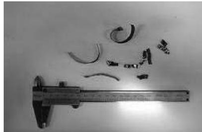
$v_c=38.4$  [m/min]、 $f=0.2$  ( $n=611$  [rpm]、 $v_f122$  [mm/min])
