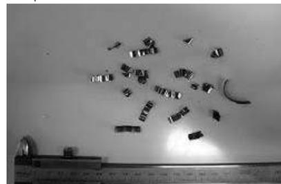
$v_c=38.4$  [m/min]、 $f=0.24$  ( $n=611$  [rpm]、 $v_f146$  [mm/min])
