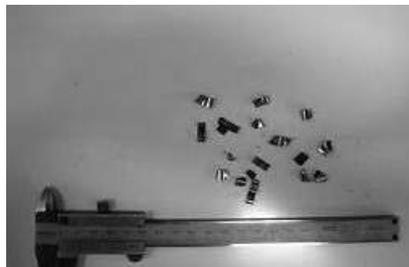
$v_c=48$ [m/min]、 $f=0.26$  ( $n=764$ [rpm]、 $v_f198$ [mm/min])
